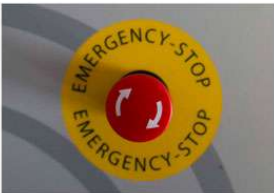
Botón de emergencias. Al accionarlo la máquina se detiene al instante
