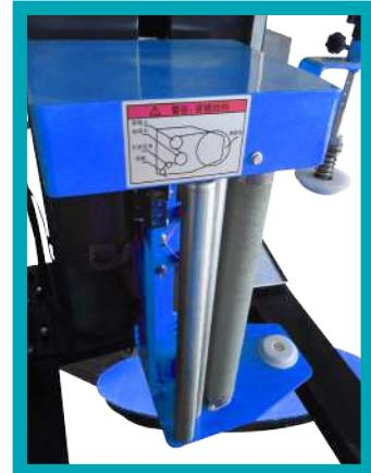
Sistema de preestirado motorizado con 2 rodillos, comandado electrónicamente con desarrollos intercambiables: 150 - 200 - 250%
