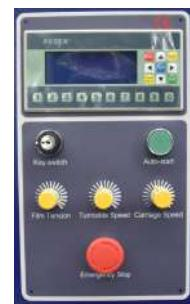
Panel operativo con un programa seleccionable y otros parámetros opcionales tales como envoltura de refuerzo en la parte superior e inferior, velocidad de rotación, velocidad de movimiento de carro hacia arriba y hacia abajo ajustable de manera individualizada, programa de aplicación de lámina "top-cover" y de lectura de altura.
