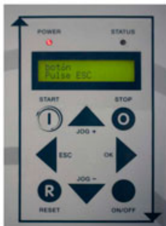
Mecanismo para activar el refuerzo de film. Con el cual podrás reforzar tus cargas en la parte superior, media o inferior con los llamados "cintos de Film"
