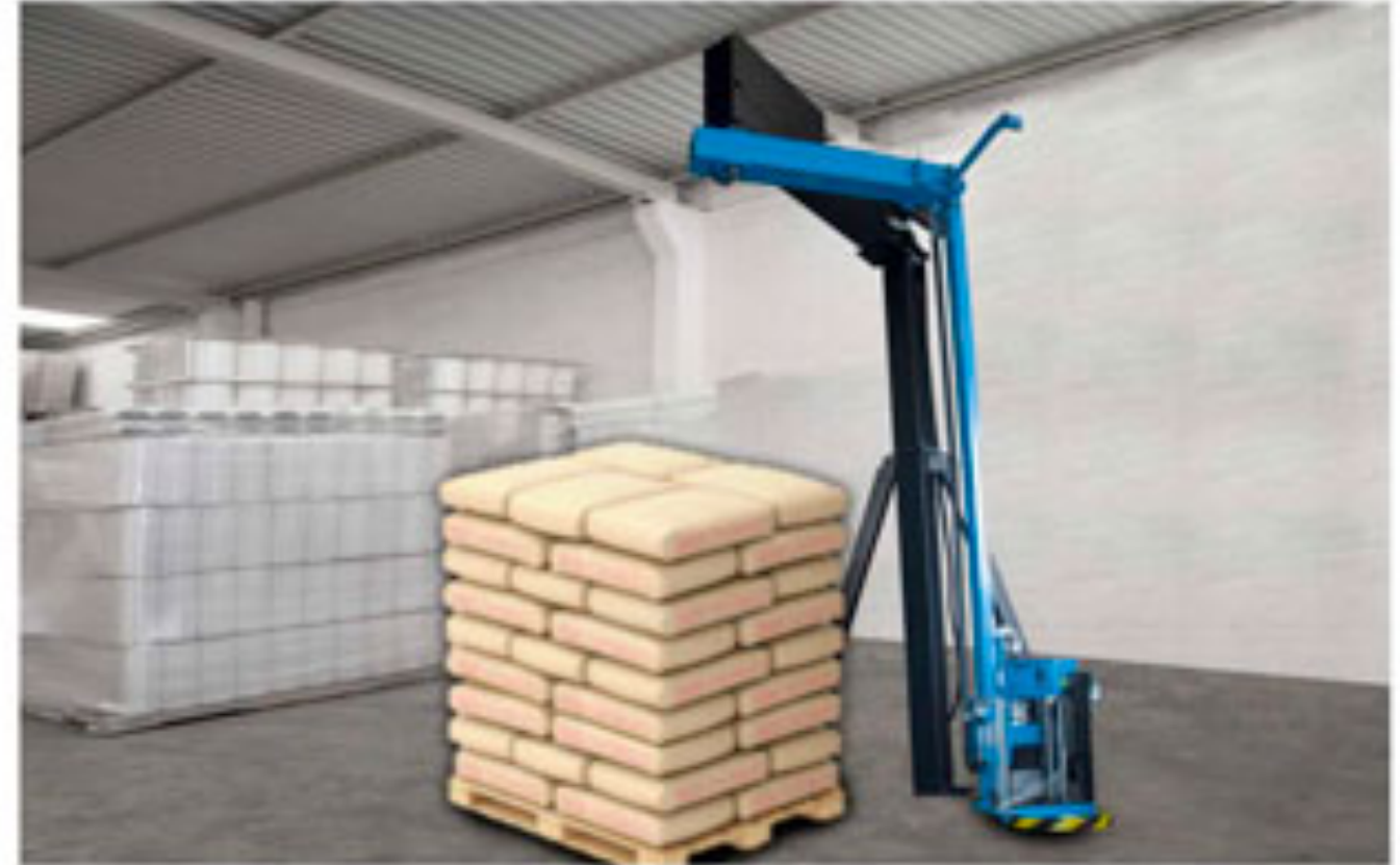
Capacidad de emplear tarimas de cualquier peso (0-∞), debido a que no se requiere poner sobre ningún plato giratorio.
